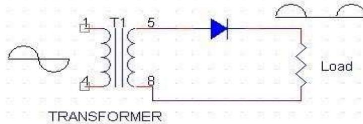
Fig.2.1.3 Half Wave Rectifier
