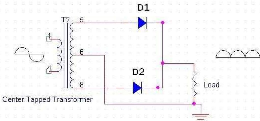
Fig.2.1.4 Full Wave Rectifier
