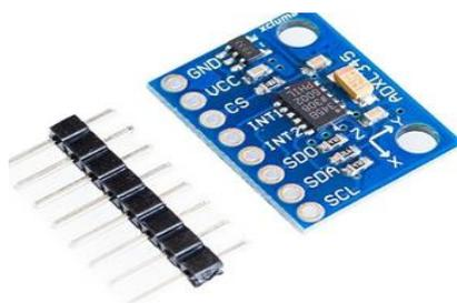
**Fig 4:** accelerometer
