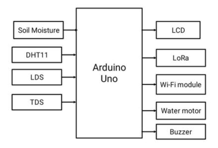
Fig 1:Block Diagram
