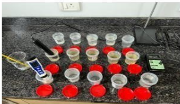
Fig.6.7:DataCollectionusingaDigitalMultiparameter and a Nephelometer
